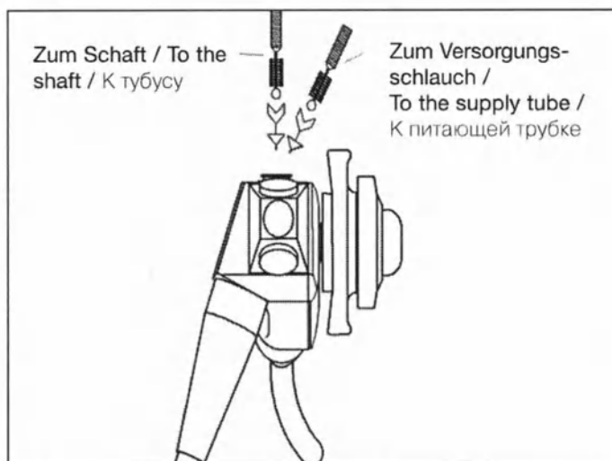
Reinigungsbürsten einführen / Insert the cleaning brushes / Ввести чистящие щетки
