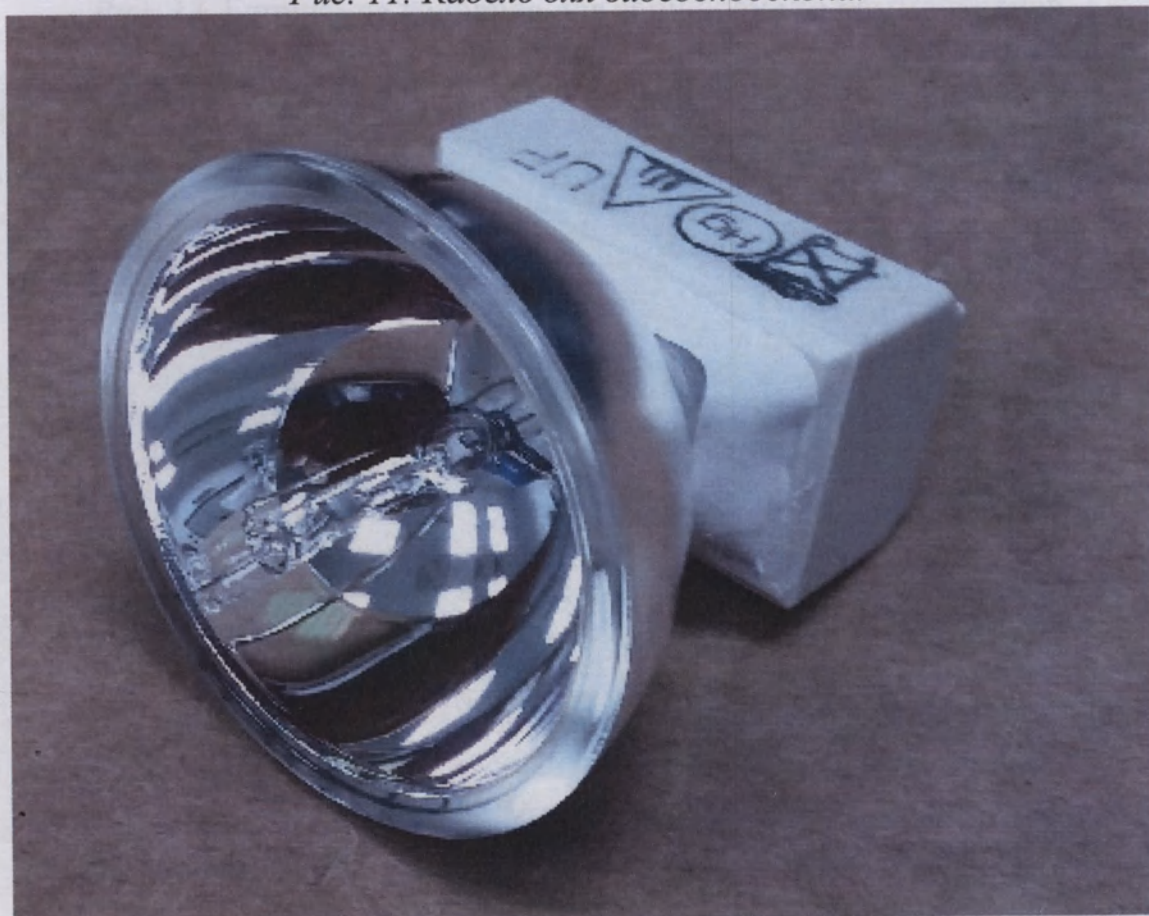
Рис. 12. Лампа, тип HiLux, для освещения объекта изображения.
