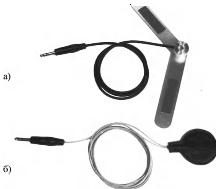
Рис. 4. Датчики синхросигналов а – угловой синхро датчик, б – контактный синхро датчик.
