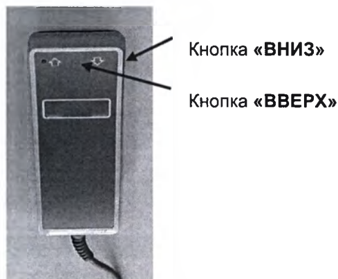
Пульт управления подъемного стола
