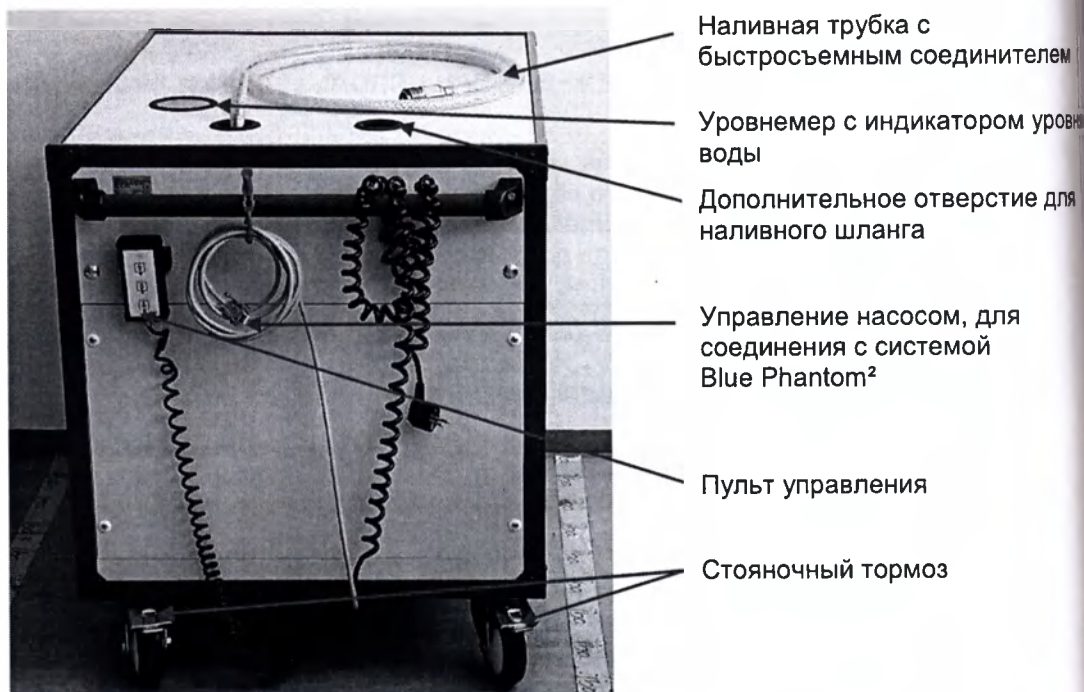
Мобильный водный резервуар типа 306/1 или 306/2 с двунаправленным насосом
