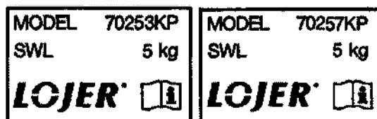
Рис.99 Таблички для столика приема пищи (на примере артикулов 70253KP и 70257KP, безопасная рабочая нагрузка 5 кг)
