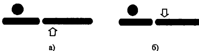
Рис. 67 Обозначения кнопок регулирования высоты кровати: а) подъем; б) опускание
