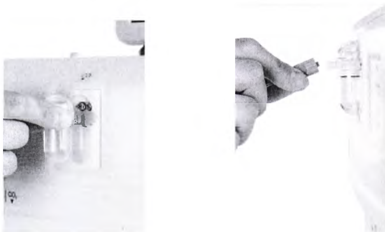
Рис. 5.8 – Установка влагоотделителя и подключение трубки линии отбора пробы
