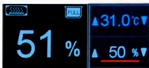
Рис. 5-8. Измерение влажности и управление влажностью
