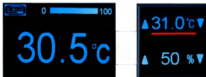
Рис. 5-6. Измерение температуры и управление температурой (режим воздуха)
