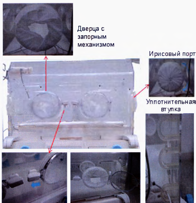
Рис. 3-9а. Вид колпака спереди и дверцы с запорным механизмом / ирисовый порт
