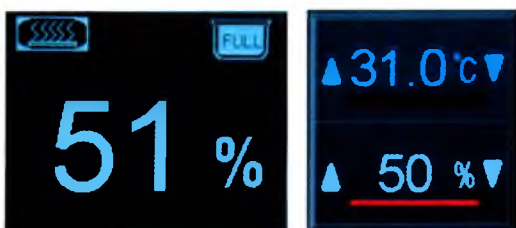
Рис. 8. Измерение влажности и управление влажностью
