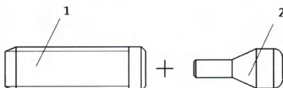
2.2.2 Схема сопряжения имплантата дентального с формирователем десны
