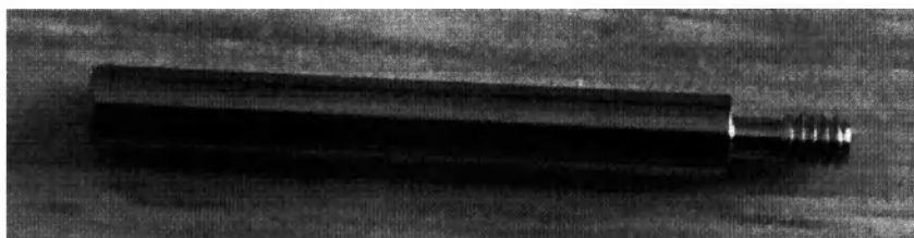
Рис.2.21 Винт SSMU для установки трансфера
