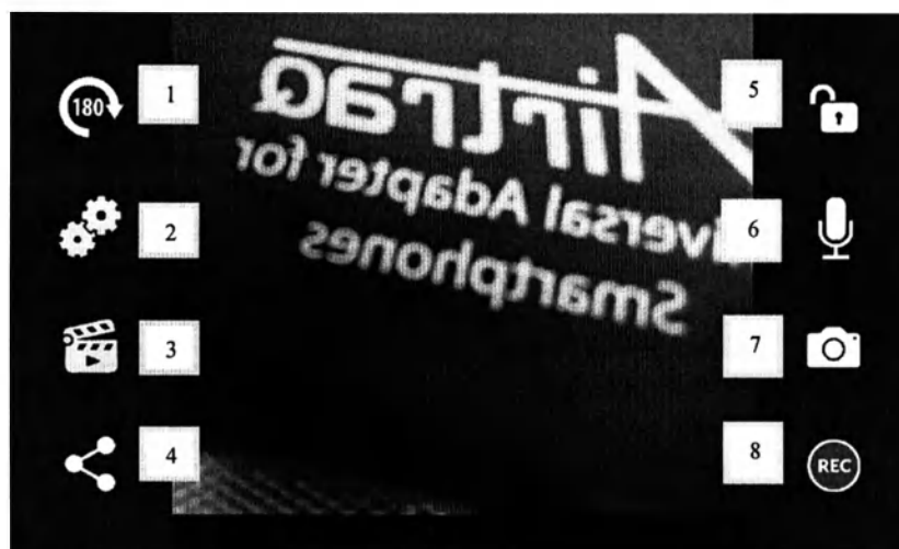
Рис. 6 Главный экран работы с приложением: 1) поворот изображения изображения на 180°; 2) кнопка установки настроек; 3) воспроизведение видеозаписей; 4) отправка данных на другие устройства; 5) кнопка блокировки экрана; 6) звукозапись; 7) фотосъемка; 8) начало идеозаписи
