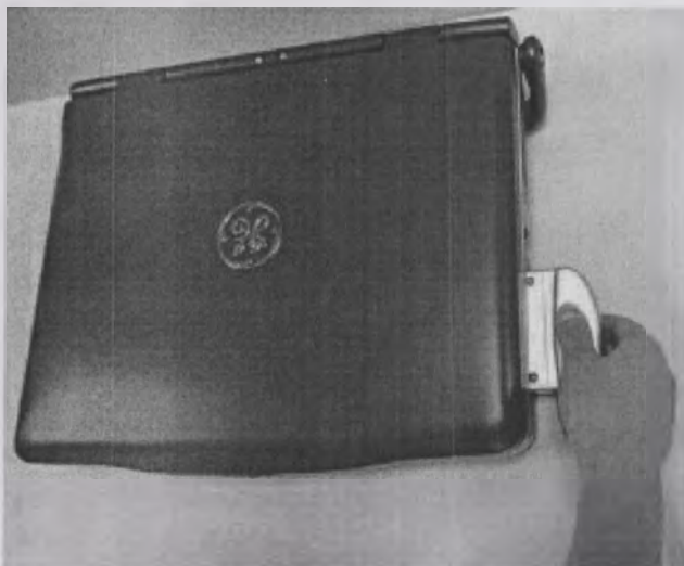
Рис. 1-35. Подсоединение датчика к системе LOGIQ V2/LOGIQ V1
