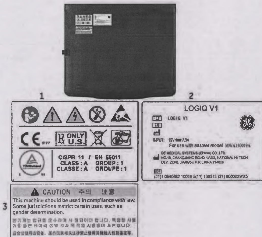
Рис. 4-2. Расположение наклейки системы LOGIQ V1
