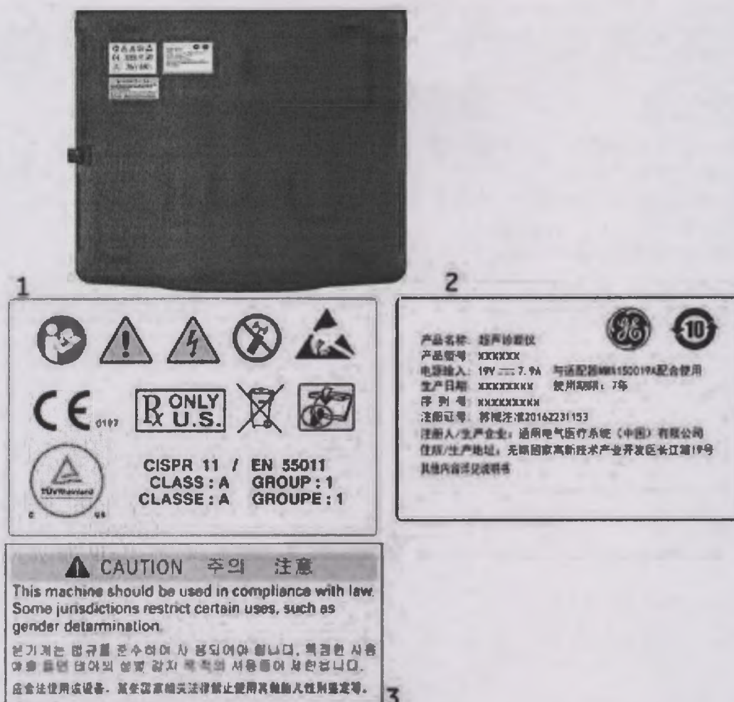
Рис. 4-4. LOGIQ V2/LOGIQ V1: расположение наклеек (для Китая)
