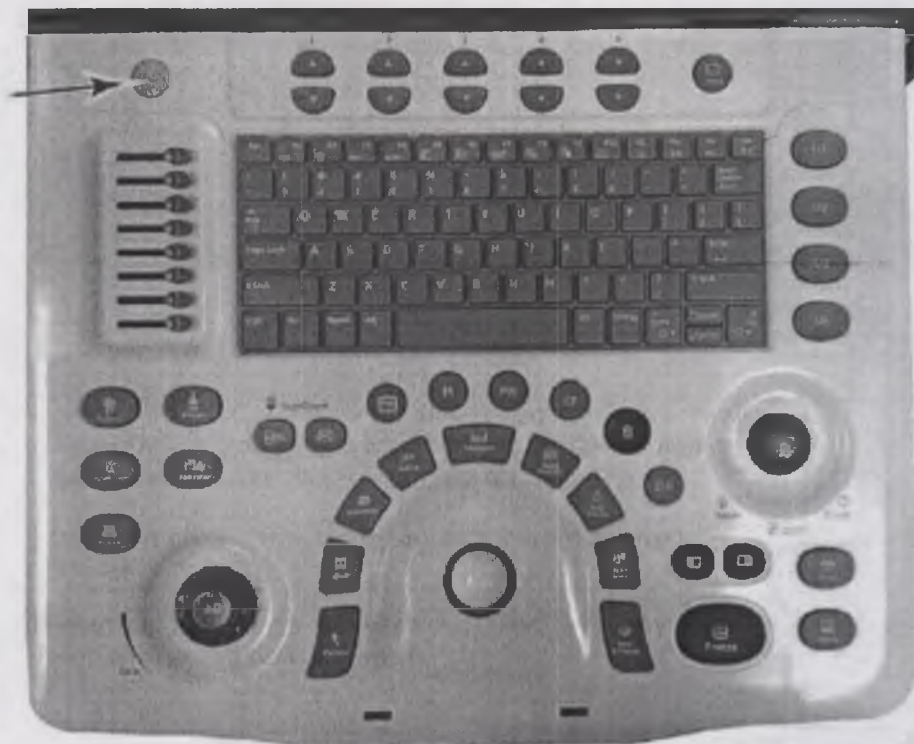
Рис. 1-32. Местоположение выключателя питания
