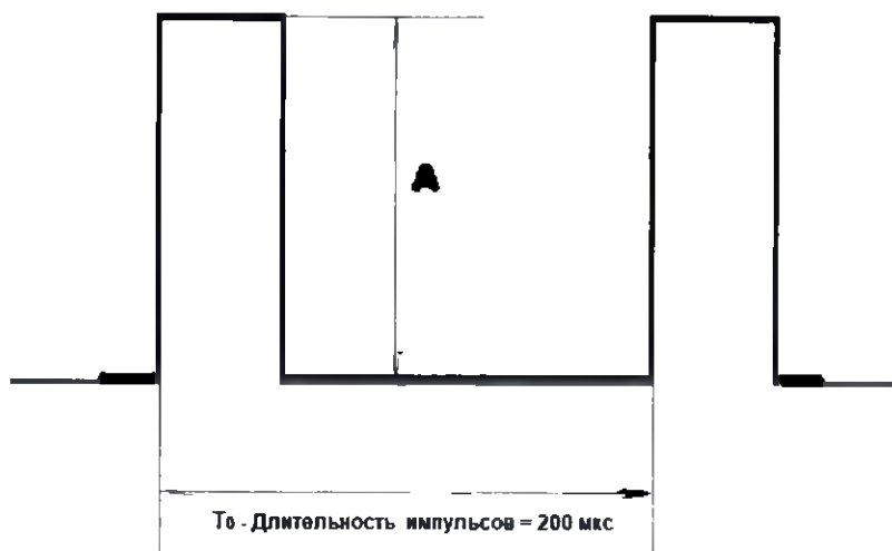
Рис.1 Вид импульсного напряжения генерируемое аппаратами ЭСМА
