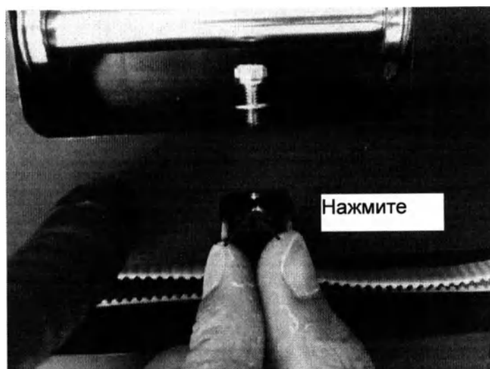
Рисунок 61. Прижмите ремень с блоком вручную и нажмите вниз
