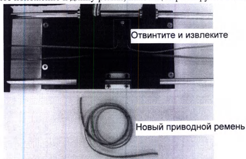
Рисунок 60. Снимите старый приводной ремень
