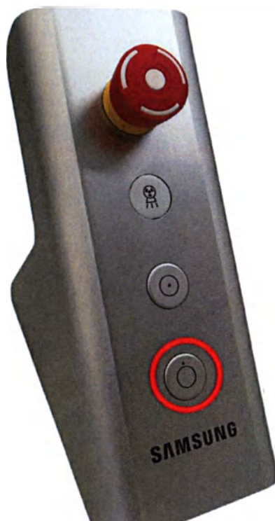
Рисунок 3-139. Отключение с использованием платы интерфейсов CIB.
