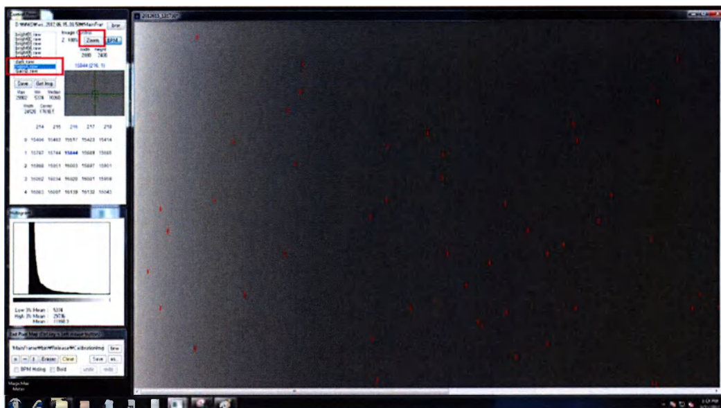
Рисунок 4-68. Обнаружение «битых» пикселей
