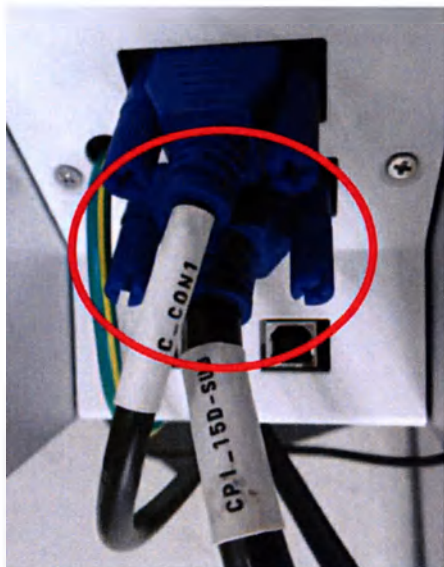
Рисунок 3-98. Подключение пульта управления СІВ
