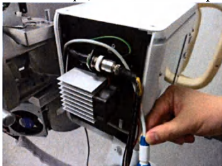
Рисунок 3-171. Подключение кабеля DAP
