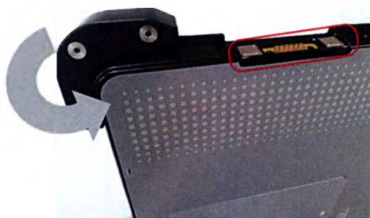
Рис. 7-22. Отсоединение сетки от цифрового детектора
