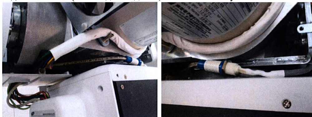
Рисунок 3-35. Подключение кабеля DAP
