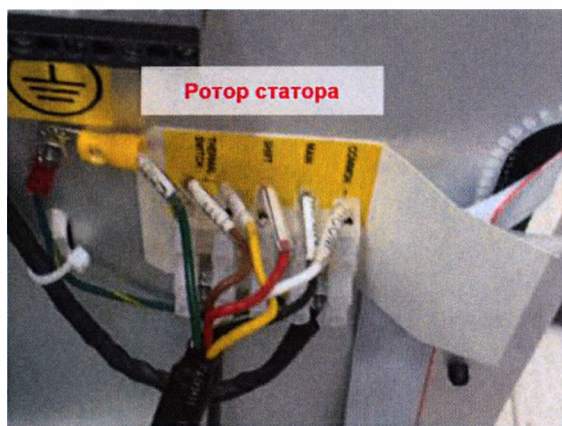
Рисунок 4-36. Подключение кабеля высокого напряжения ГВН и кабеля статора.
