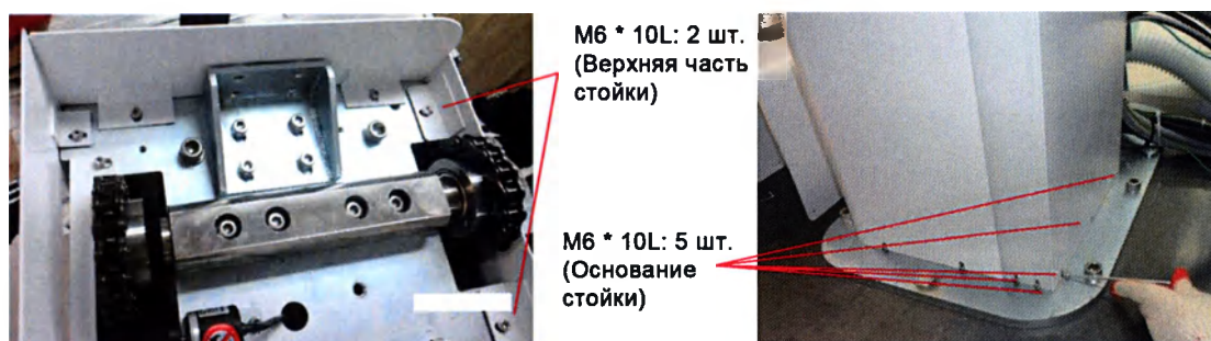
Рисунок 3-144. Монтаж стойки (правая часть корпуса)
