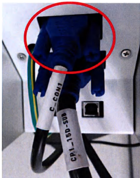
Рисунок 3-96. Подключение пульта управления СІВ
