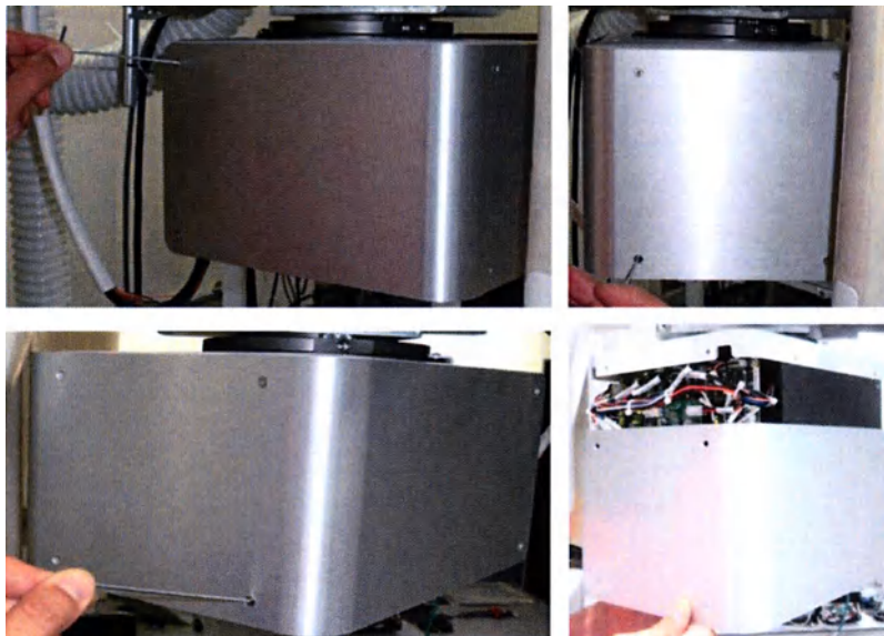
Рисунок 3-36. Передние и боковые винты для закрепления крышки отклоняющего коллиматора.
