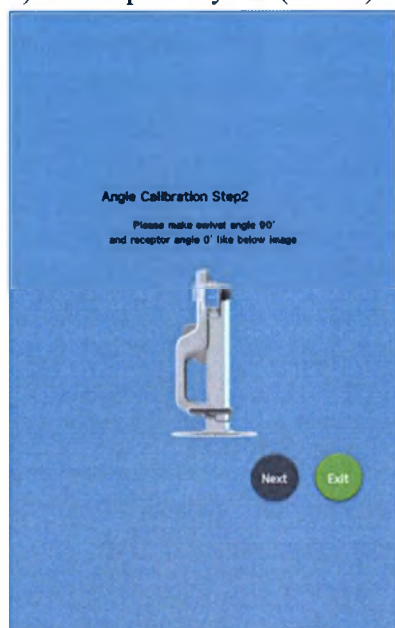
Рисунок 4-14. Калибровка угла наклона рецептора.
