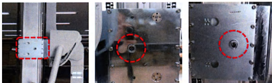
Рисунок 3-23. Позиции крепежных штифтов (2 шт.) блока шасси.
