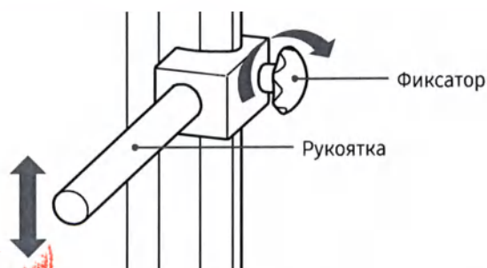
Рис. 7-5. Порядок использования рукоятки стенда для сшивания изображений
