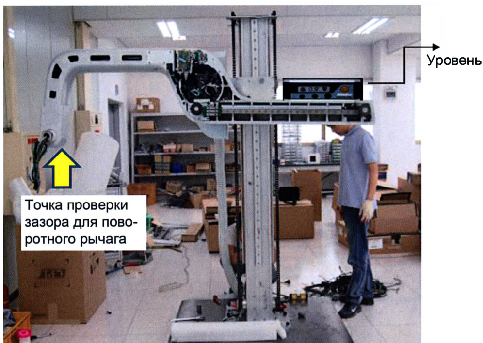
Рисунок 3-24. Поворот U-образного рычага и техника безопасности
