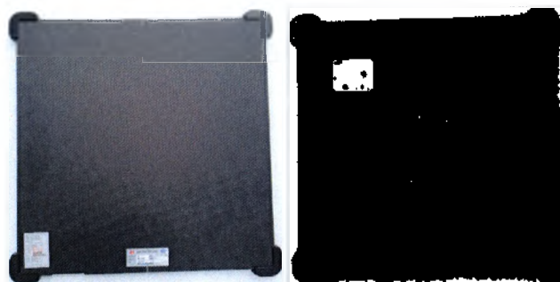
Рис. 7-21. Портативная сетка после прикрепления к цифровому детектору
