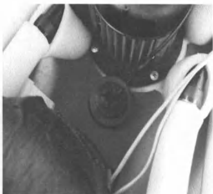
Рис. 5. Подготовьтесь к выкручиванию горловины бака.
