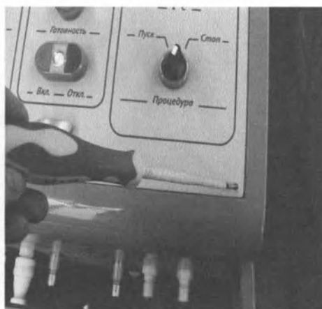
Рис. 1. Выкрутите 2 болта передней крышки аппарата.
