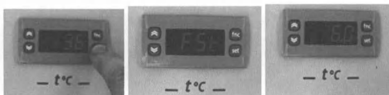
Рис. 15. Корректировка температуры готовности (достижение уставки, 3).
