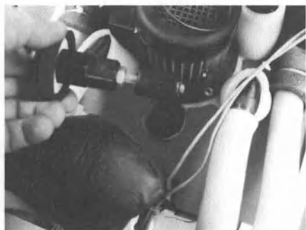
Рис. 6. Аккуратно выверните горловину бака и извлеките крышку с датчиком нижнего уровня хладоносителя
