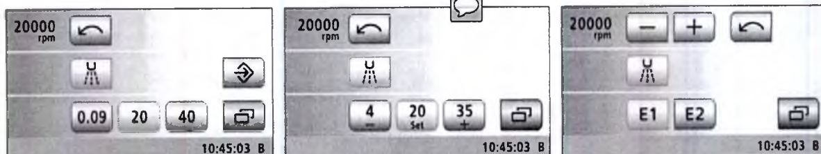
Диалог мотора со статичными кнопками быстрого выбора (слева), программируемыми кнопками быстрого выбора (в центре) и уровнями функций (справа)
