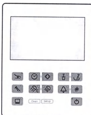
Расположение постоянных кнопок на блоке врача SINIUS CS
