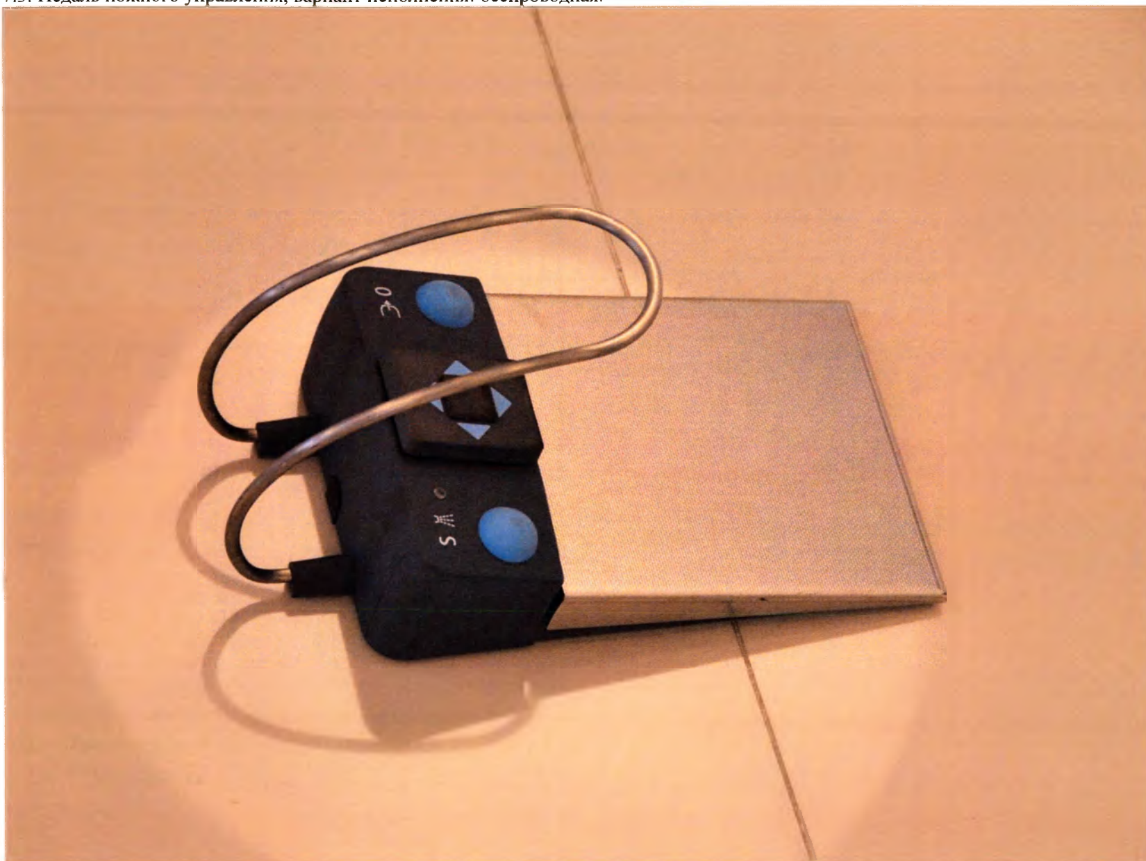
7.3. Педаль ножного управления, вариант исполнения: беспроводная.
