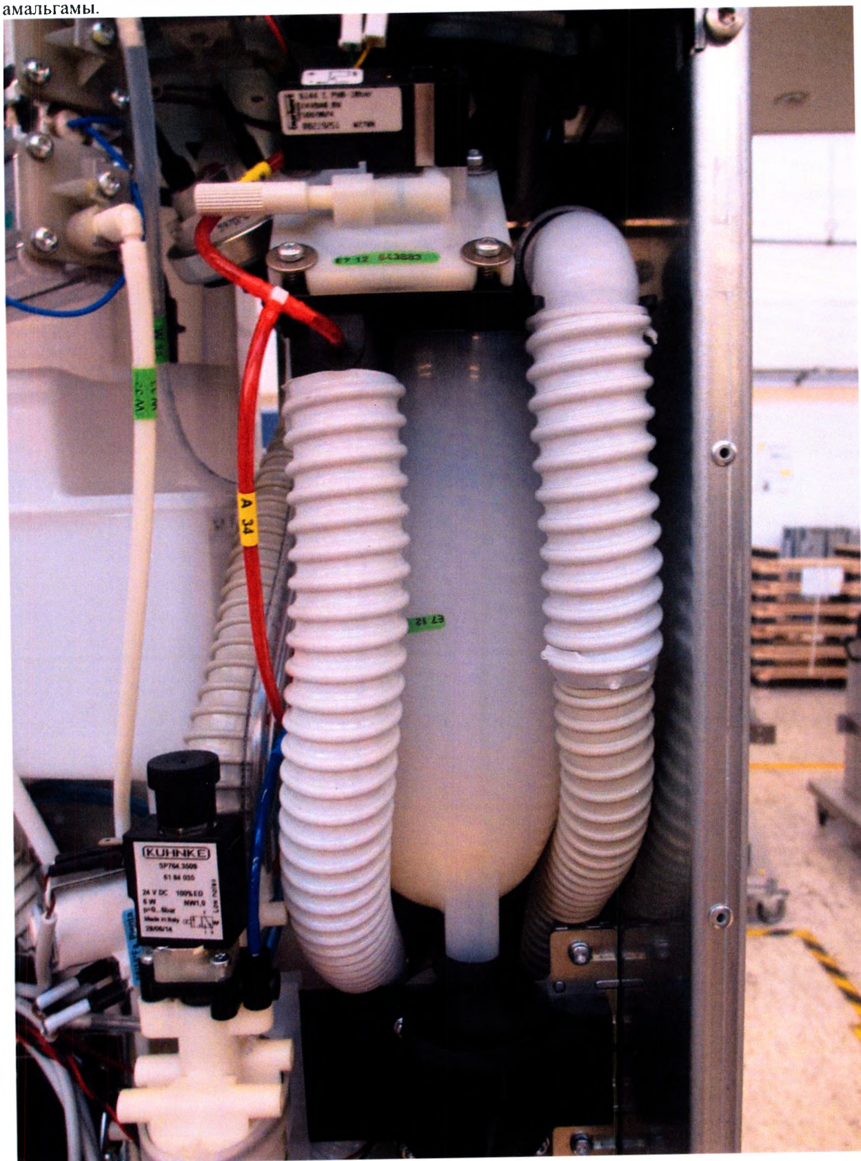
29.6. Система аспирации с элементами для подключения, вариант исполнения: отделитель амальгамы.
