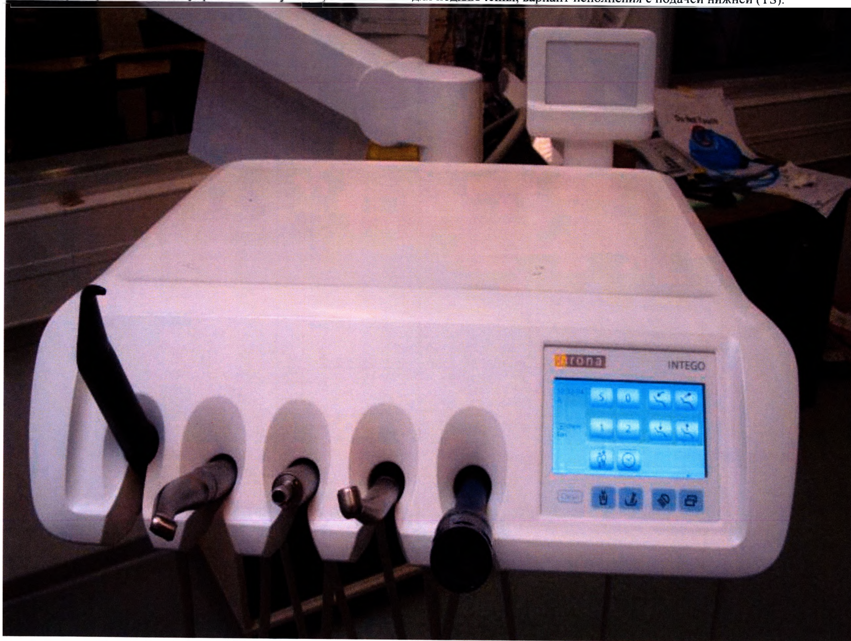
2.6. Модуль врача с панелью управления EasyTouch, с элементами для подключения, вариант исполнения с подачей нижней (TS).
