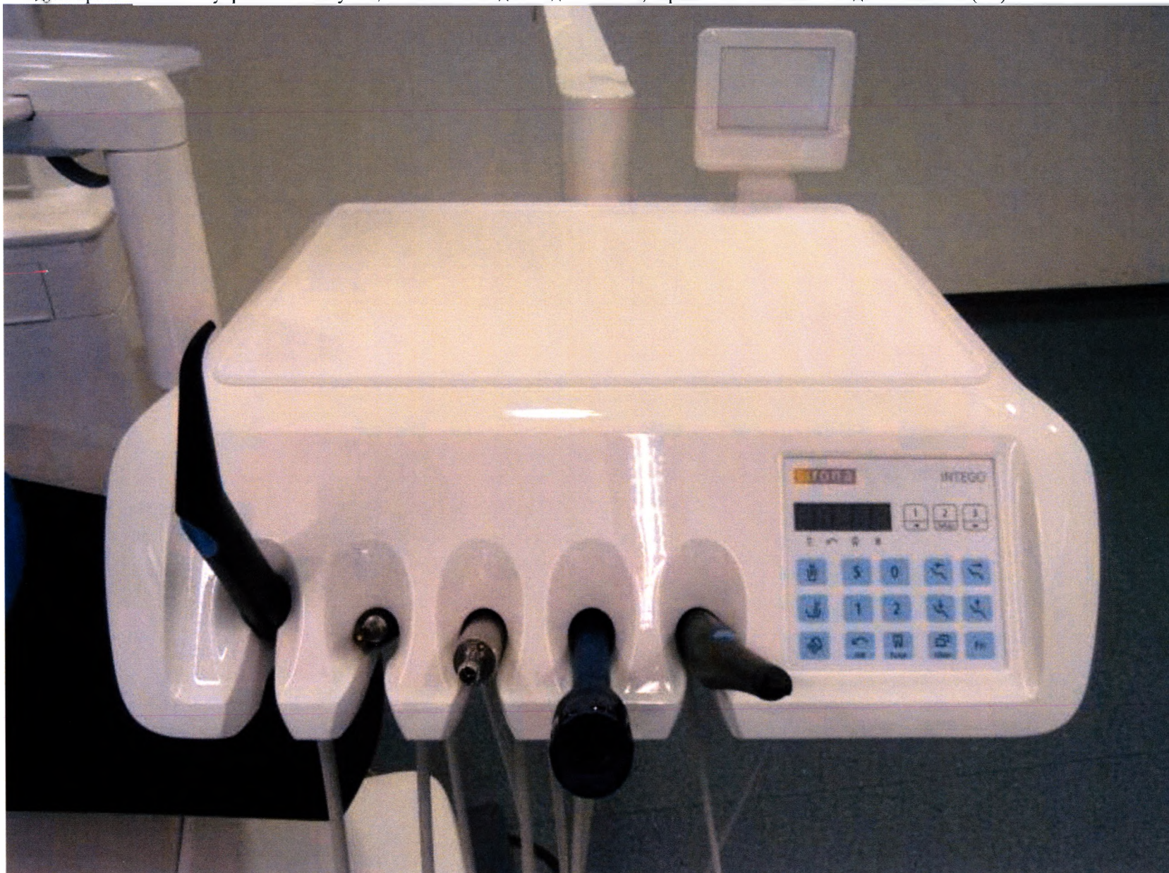
2.3. Модуль врача с панелью управления EasyPad, с элементами для подключения, вариант исполнения с подачей нижней (TS).
