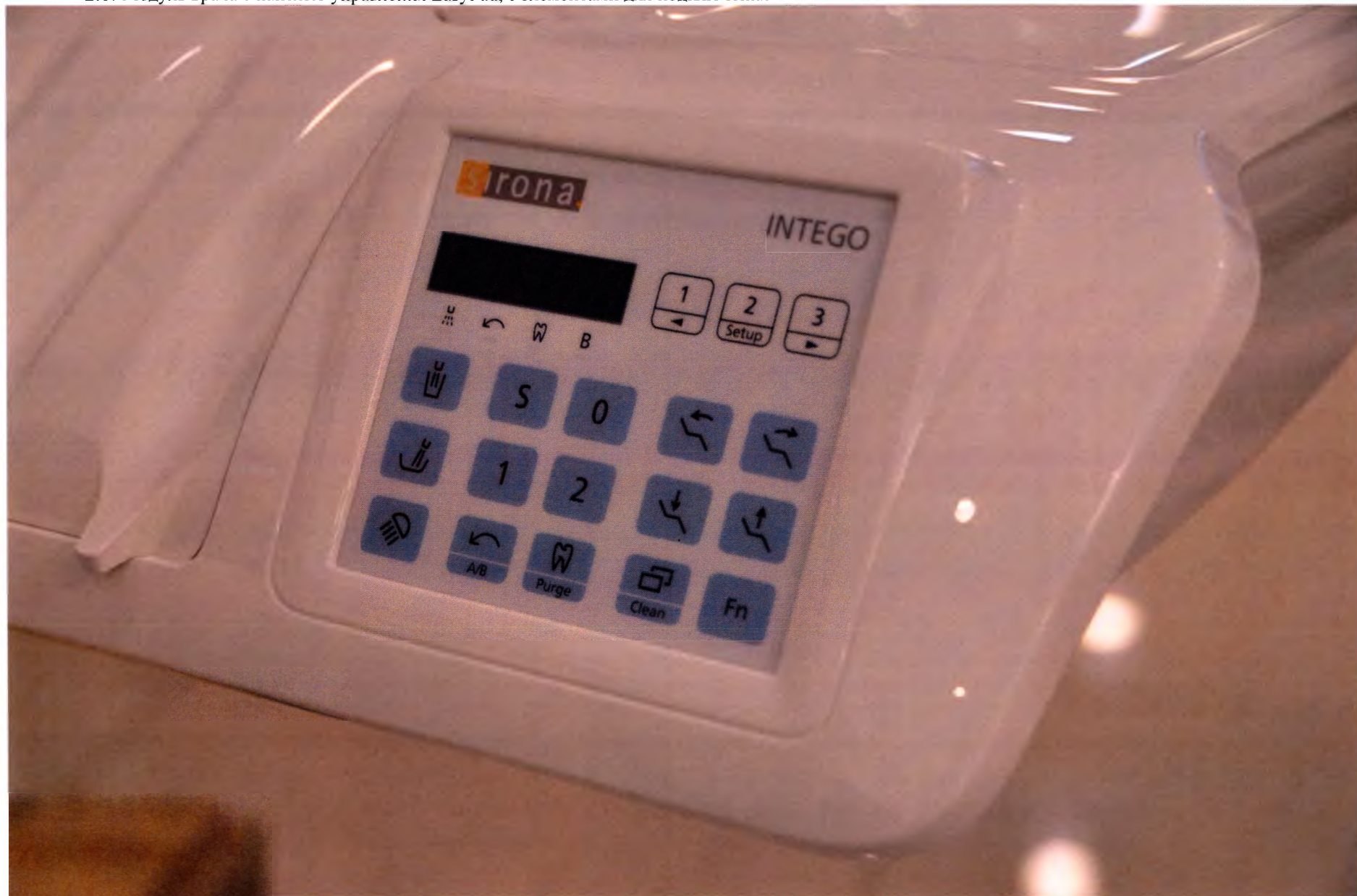
2.1. Модуль врача с панелью управления EasyPad, с элементами для подключения
