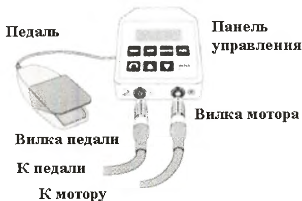
Рис.2. Как собрать Морцеллятор TCM 3000 BL для хирургических операций
