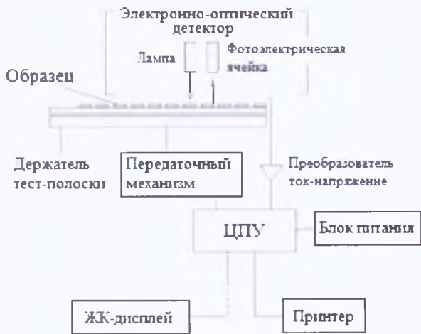
Рисунок 1 – Функциональная схема CL-50 Plus
