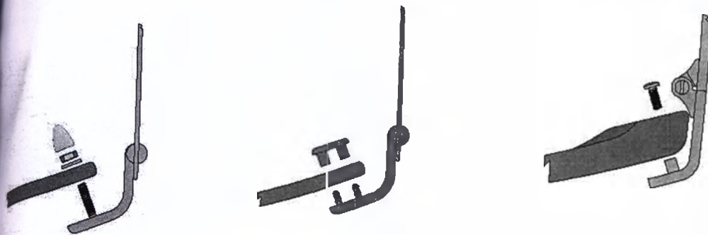
Схемы крепления линзы к оправе в безободковых оправках.
