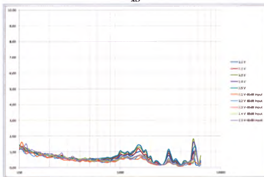
Изменение коэффициента гармоник при изменении напряжения питания x_S
