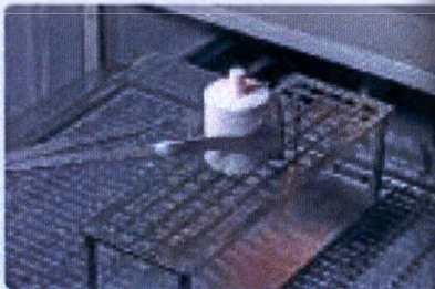
По окончании программы прессования вынуть горячую опопу с помощью муфельных щипцов, поставить ее на решетку для охлаждения и оставить остывать в месте, защищенном от сквозняков
