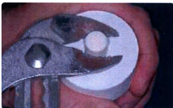
Разделите опоку в соответствии с маркировкой с помощью сепарационного диска
