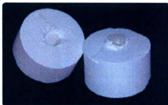
Разделите опоку в соответствии с маркировкой с помощью сепарационного диска
