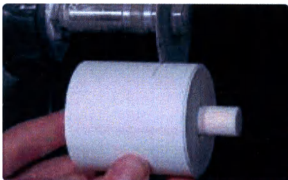
Разделите опоку в соответствии с маркировкой с помощью сепарационного диска
