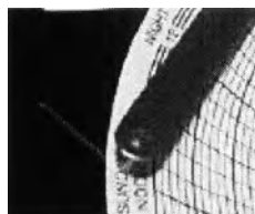
Рис. 21 – Установка пера относительно бороздки, обозначающей линию времени
