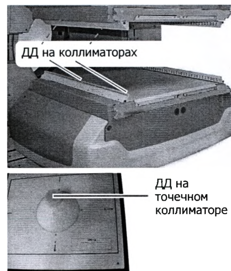
Рис. 3-5. Расположение датчиков давления
