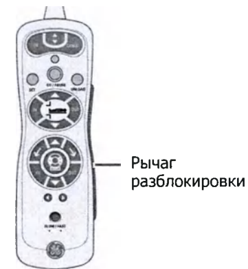
Рис. 3-6. Расположение рычага РАЗБЛОКИРОВКИ на ручном пульте управления
