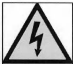
Опасно! Высокое напряжение!
