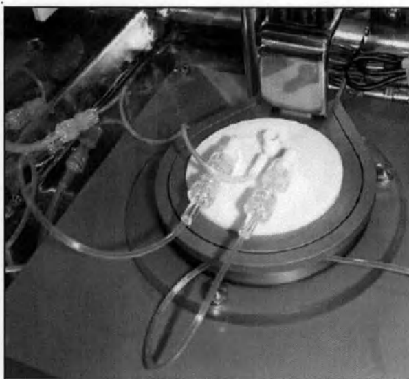
Вид бутылки массовой дозы, установленной на весы
