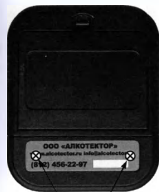
места установки крепежных винтов под наклейкой
