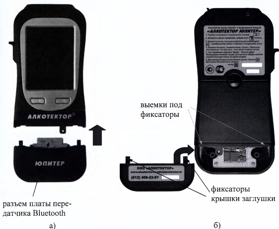
Рисунок 32 – Подсоединение заглушки к основному блоку анализатора
