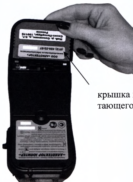
Рисунок 30 – Отсоединение крышки печатающего блока
