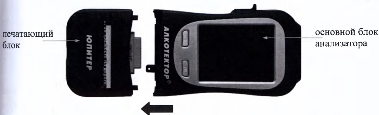
Рисунок 31 – Отсоединение печатающего блока
