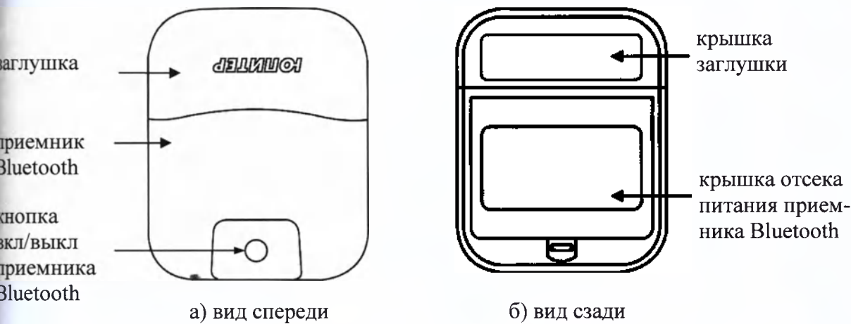
Рисунок 28 – Приемник Bluetooth и заглушка в соединенном виде
