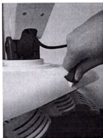
Рис. 4.9. Подключение кабеля, идущего от шарнирного манипулятора
