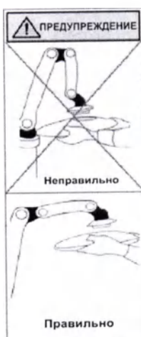
Рис. 2.6 Перевод текста предупредительной таблички по замене установленного лампового блока
