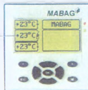
Рисунок 36: Отображение показаний датчика-эмулятора температуры
