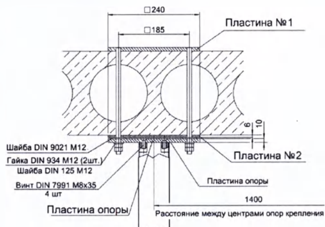
Рис. 4 Крепление опор крепления консоли к потолочному перекрытию
