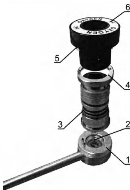
Рис. 2 Клапан медгазов в монтажном корпусе (основные компоненты)
