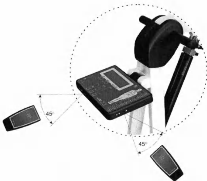
Рис. 4.2. Положение устройства включения относительно датчика сигналов
