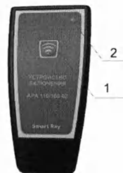
Рис. 4.1. Устройство включения (Пульт дистанционного управления) 1 – кнопка снимков, 2 – индикатор включения
