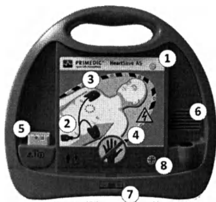
Рис.3 Элементы управления дефибриллятора PRIMEDIC HeartSave AS (M250)
