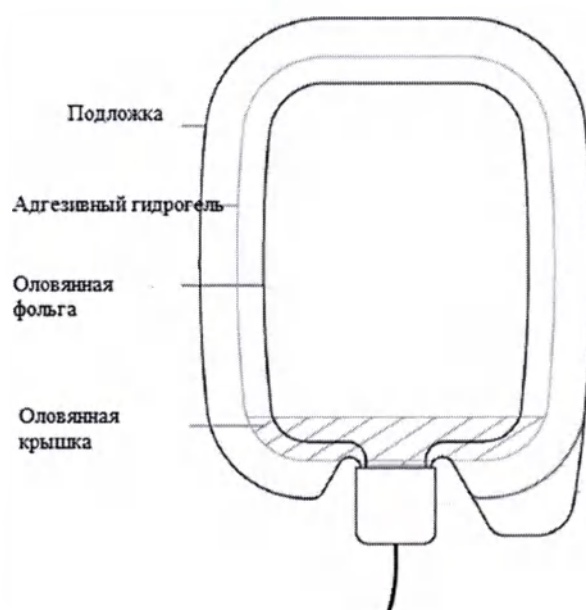
Рис.15 Электрод одноразовый самоклеящийся дефибрилляционный PRIMEDIC (вид сверху)
