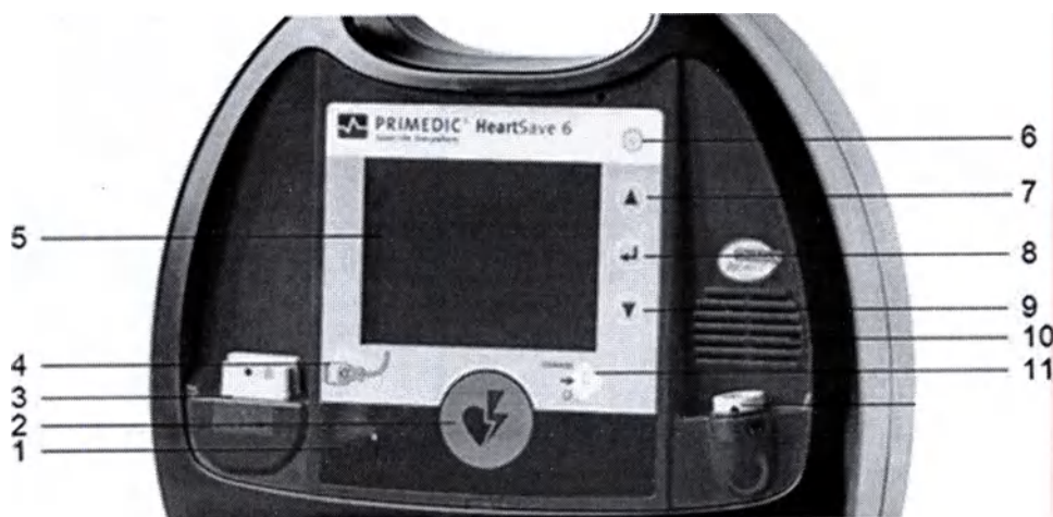
Рис. 13 Элементы управления дефибриллятора PRIMEDIC HeartSave 6
