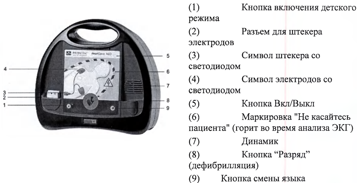
Рис.6 Элементы управления дефибриллятора PRIMEDIC HeartSave AED (M250)
