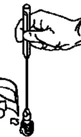
Рис. 2: Прикрутите ручку к держателю, который зафиксирован на клапане, извлеките защитный стакан с клапаном из индивидуального контейнера.
