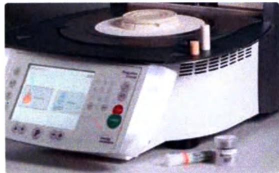
Выберите холодный изолированный стержень из оксида алюминия IPS Alox-Plunger и холодную заготовку IPS e.max Press Ingots требуемого цвета.
