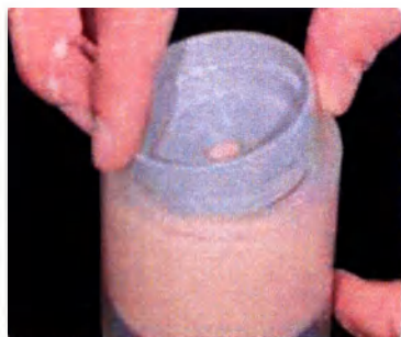
Заполните кольцо для паковки до отметки и установите кольцо-калибр IPS Ring Gauge поворотнo-откидным движением. Прижмите кольцо-калибр к кольцу силиконовому IPS Silicone Ring до упора. Избыточная паковочная масса выходит через отверстие. Выдержите паузу для схватывания кольца для паковки, не совершая с ним манипуляций.
