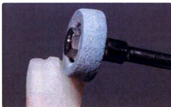
Выполните шлифование точек крепления литьевого канала с низкой скоростью и слабым нажимом, а также отделку поверхностей.
