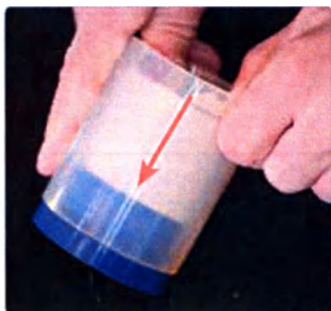
Осторожно вытолкните кольцо для паковки из кольца силиконового IPS Silicone Ring.
