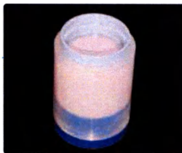
Заполните кольцо для паковки до отметки и установите кольцо-калибр IPS Ring Gauge поворотнo-откидным движением. Прижмите кольцо-калибр к кольцу силиконовому IPS Silicone Ring до упора. Избыточная паковочная масса выходит через отверстие. Выдержите паузу для схватывания кольца для паковки, не совершая с ним манипуляций.
