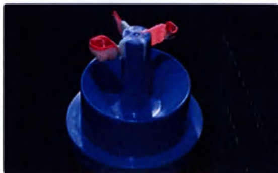
Подготовленное кольцо-основание IPS Multi Muffelsystem Ring Base с закрепленной воском восковой моделью
