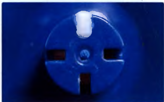
Уплотните неиспользуемые отверстия в кольцевом основании для паковки избыточным количеством воска.
