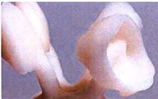
Удалите реакционный слой, образующийся на прессованных объектах, с использованием жидкости IPS e.max Press Invex Liquid в ультразвуковой ванне
