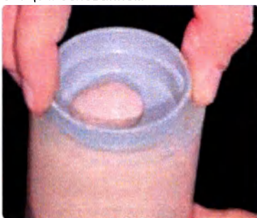
Заполните кольцо для паковки до отметки и установите кольцо-калибр IPS Ring Gauge поворотнo-откидным движением. Прижмите кольцо-калибр к кольцу силиконовому IPS Silicone Ring до упора. Избыточная паковочная масса выходит через отверстие. Выдержите паузу для схватывания кольца для паковки, не совершая с ним манипуляций.
