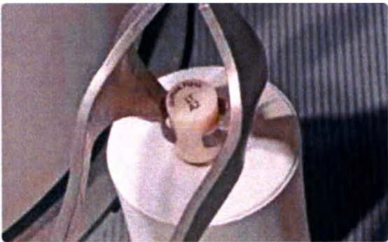
Поместите cold заготовку IPS e.max Press Ingots в горячее кольцо для паковки цветным оттиском вверх.
