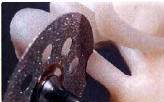
Отделите литники с помощью тонкого алмазного диска и обеспечьте постоянное увлажнение поверхности шлифования.
