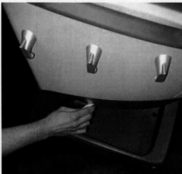
Рис. 3–7 Пружинный рычаг для отсоединения тележки
