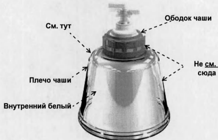
Рис. 4-7 Установка чаши для предотвращения вибрации
