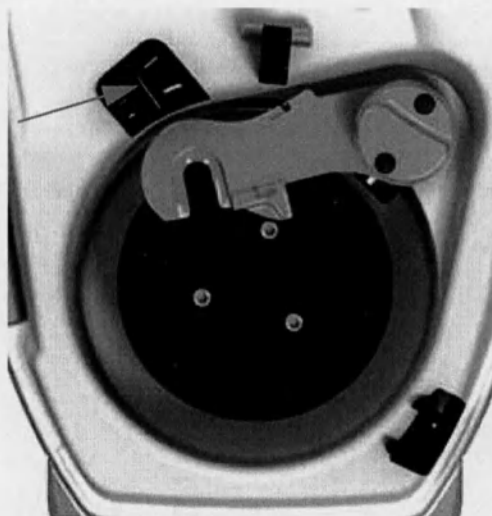
Рис. 3–17 Расположение детектора воздуха
