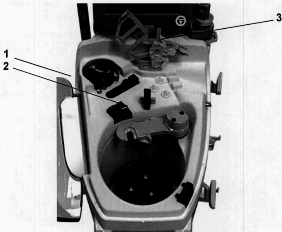
1 Крышка центрифуги 3 Крышка зажима 2 Рычаг центрифуги
