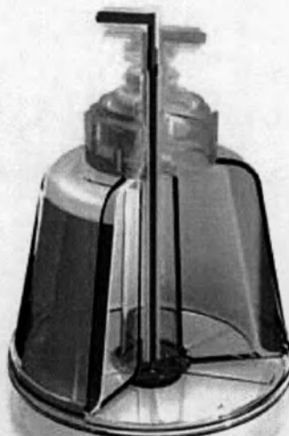
Рис. 3–32 Чаша центрифуги Латама (поперечное сечение)
