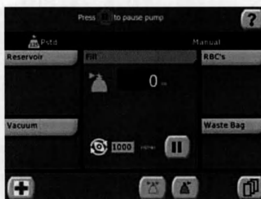
Рис. 5–29 Фаза заполнения в ручном режиме
