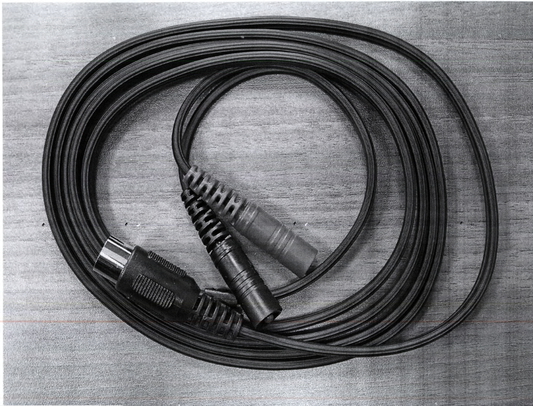
Рис 6. Кабель для электродов двухпроводный
