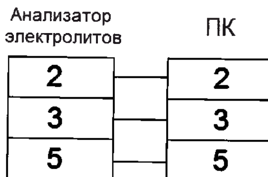
Рисунок 7- Соответствие контактов подключения
