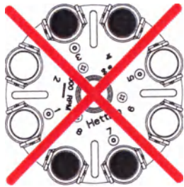
Не допустимо! Ротор загружен неравномерно
