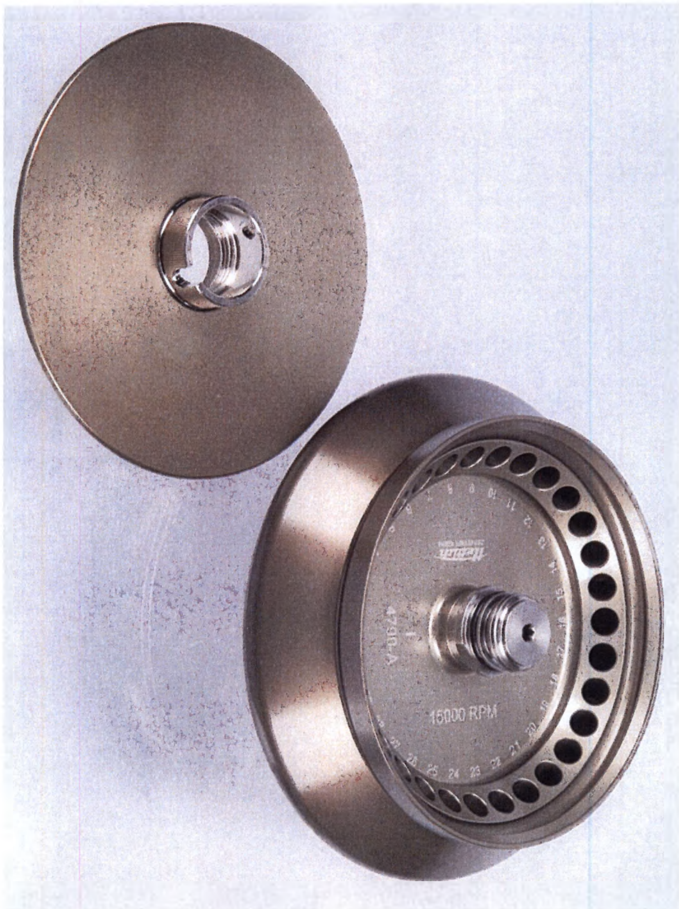
Ротор угловой, 30-местный, Ø198 мм, с крышкой, для микропробирок объемом 0.2-2 мл, угол 45°
