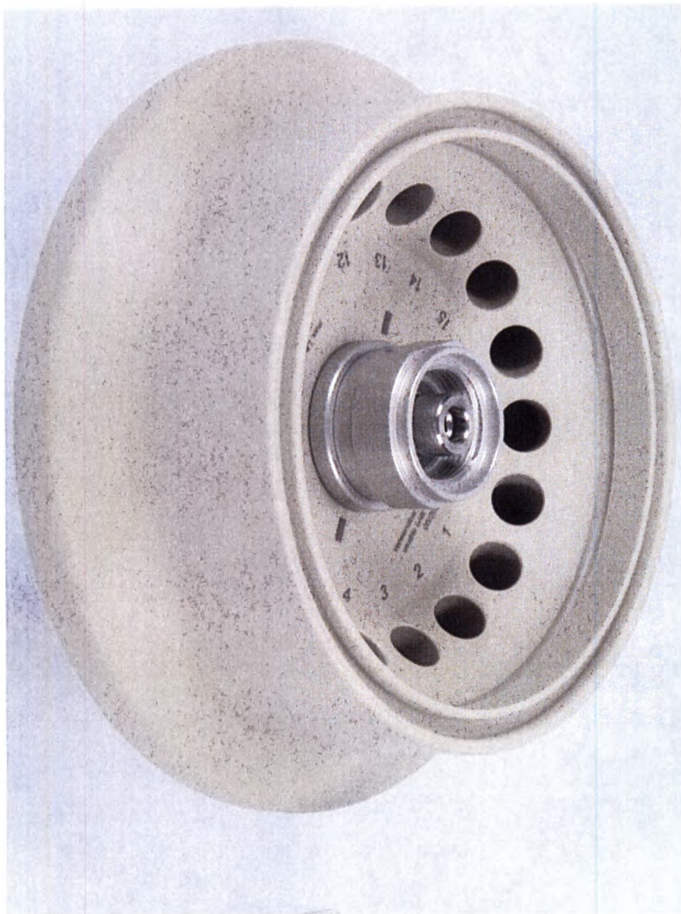
Ротор угловой, 18-местный, Ø158 мм, для пробирок объемом 0.2-2 мл, угол 45°, с крышкой
