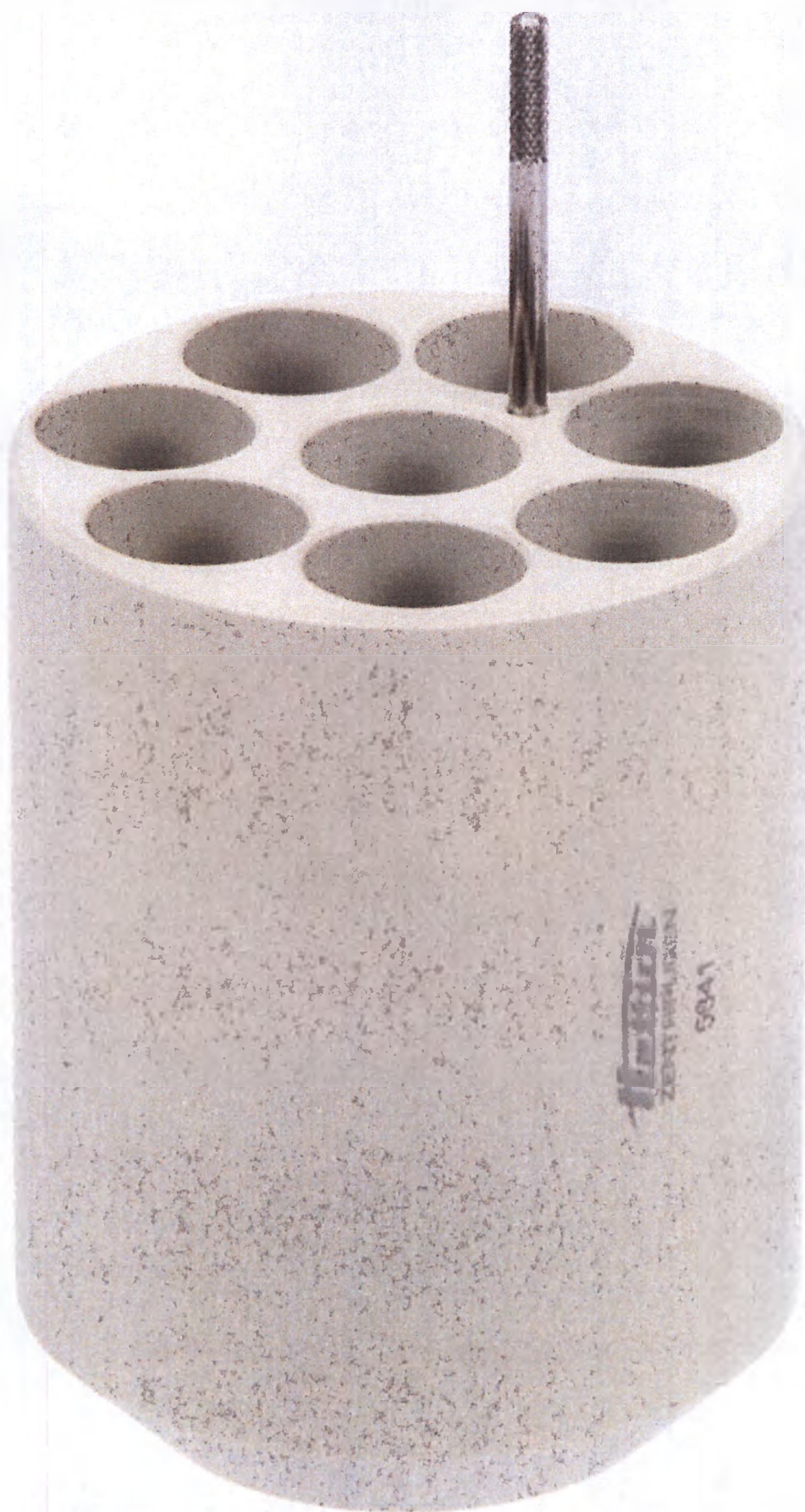
Адаптер 8-местный, для пробирок из поликарбоната объемом 10 мл
