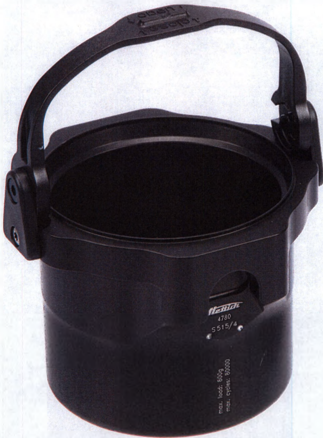
Подвес одноместный, для 4-местного ротора, в комплекте с зажимом, для размещения сосудов максимальным объемом 600 мл
