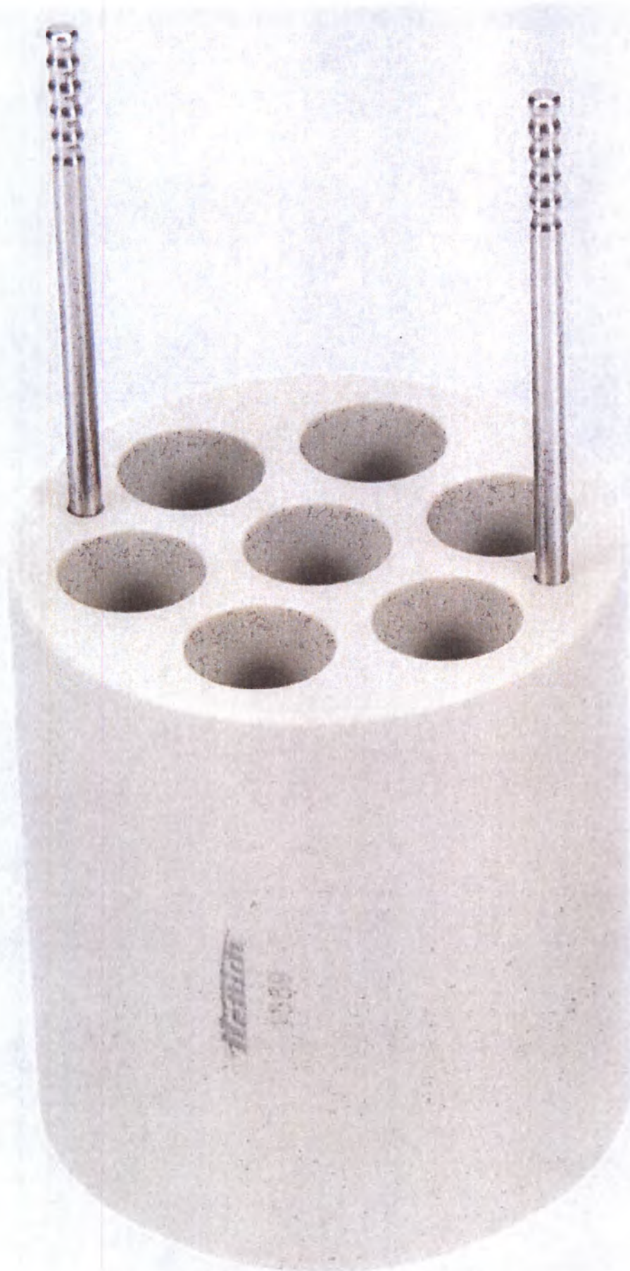
Адаптер 7-местный, для стеклянных пробирок и пробирок для забора крови / мочи объемом 1.1-7 мл
