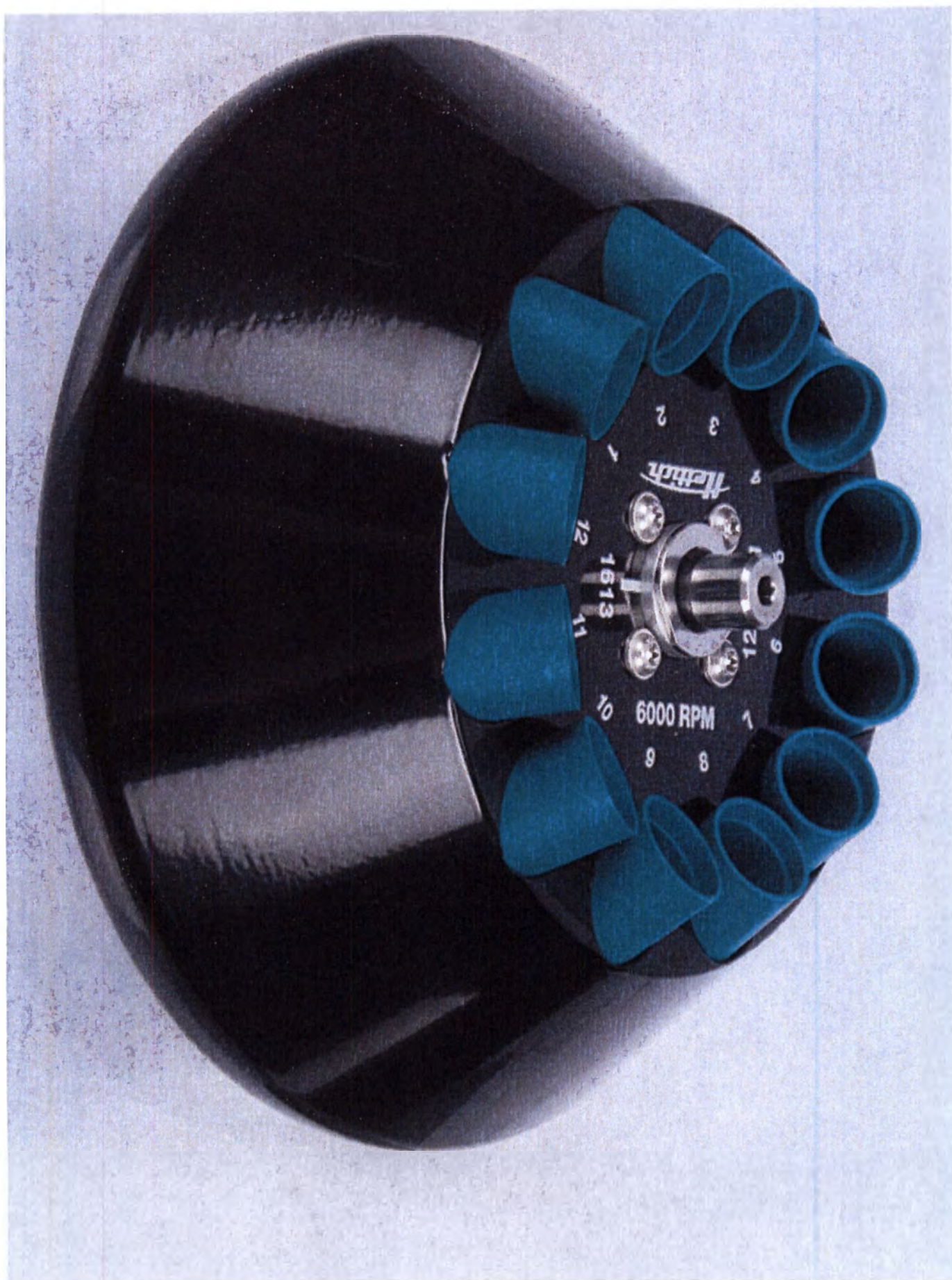
Ротор угловой, 12-местный, Ø213.3 мм, для пробирок максимальным объемом 15 мл, угол 35°
