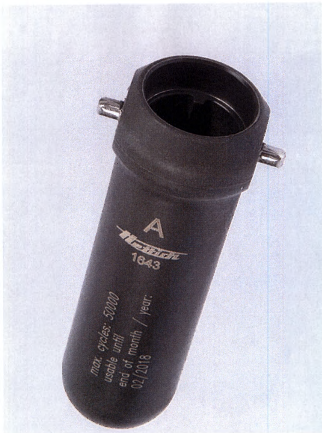
Подвес одноместный, для стеклянных пробирок и пробирок для забора крови / мочи объемом 4-7 мл
