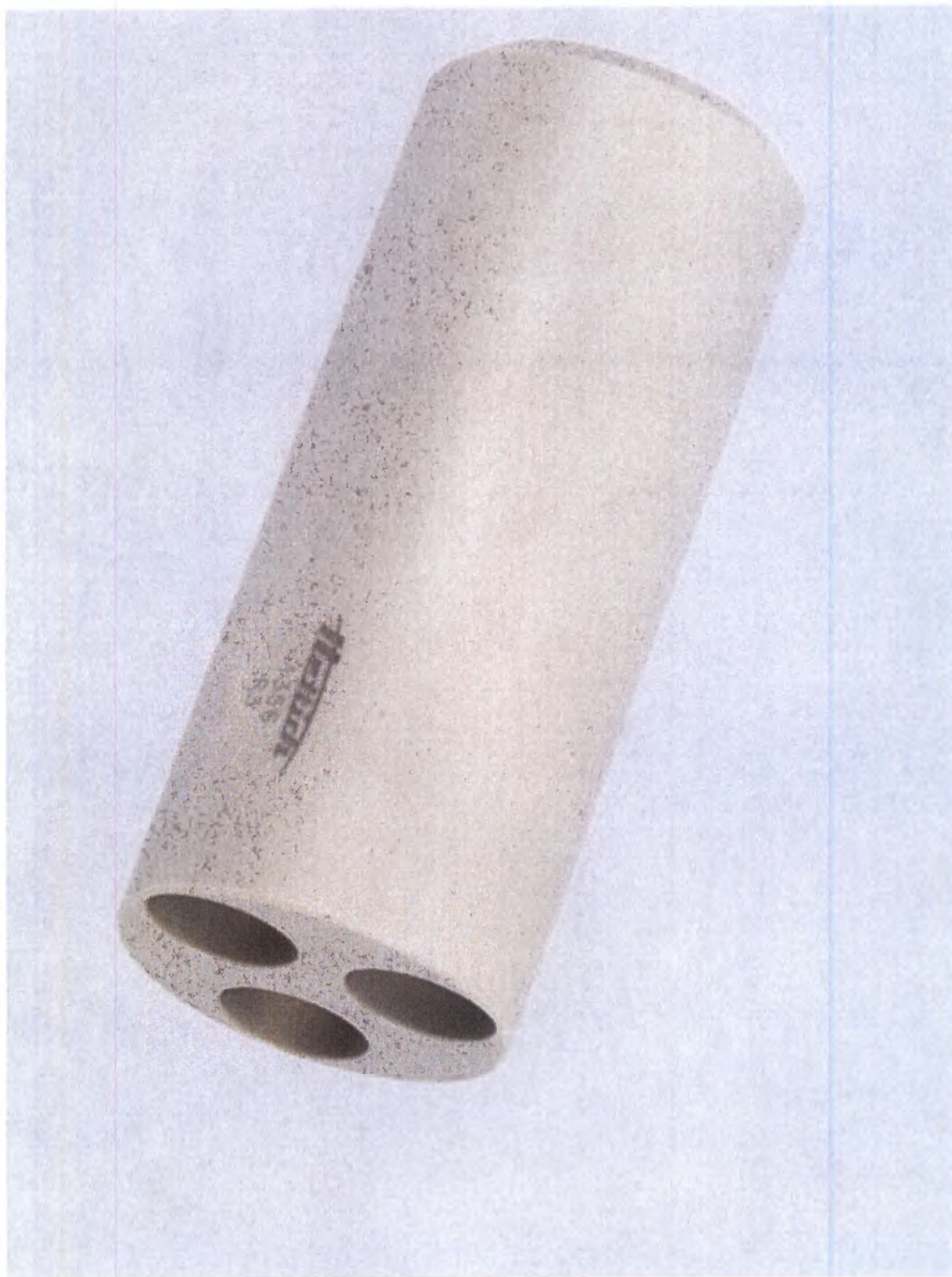
Адаптер 3-местный, для конических пробирок объемом 15 мл
