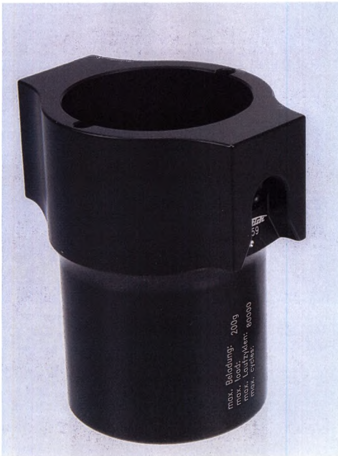
Подвес одностыный, для конических пробирок объемом 50 мл
