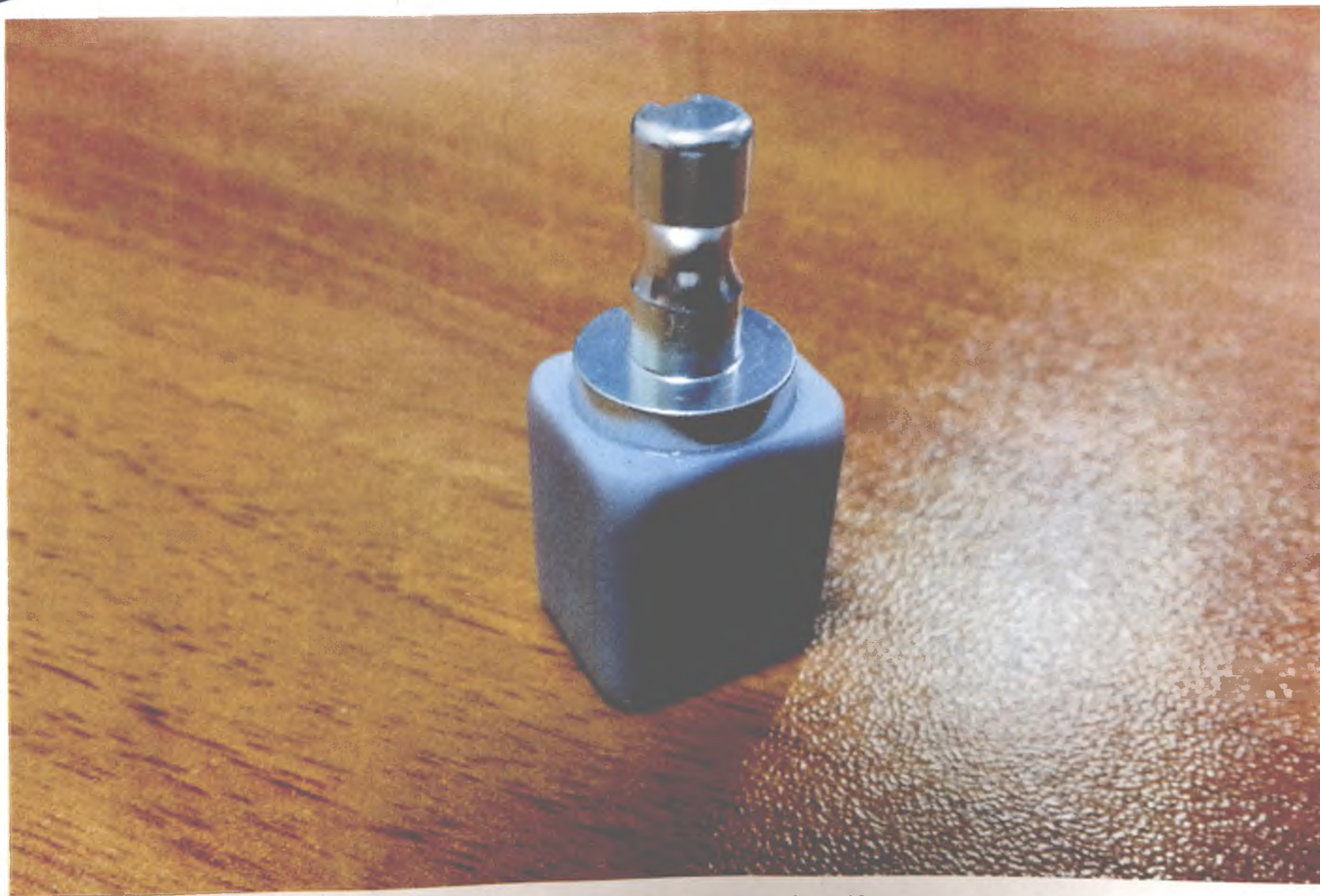
Рисунок 5. Блок стеклокерамический на основе дисиликата лития для CAD/CAM систем.
