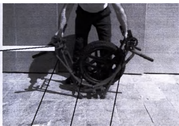
1 – рама; 2 – колеса; 3 – поперечные трубки
