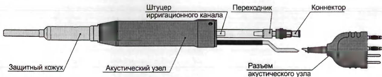
Рисунок 20 – Узел акустический ультразвуковой со сменным защитным кожухом. Исполнение 1. В сборе для аппарата моделей «АСТИТОН-А» и «АСТИТОН». Кожух сменный исполнения 1.
