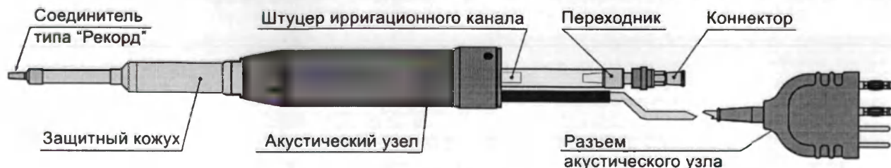
Рисунок 22 – Узел акустический ультразвуковой со сменным защитным кожухом. Исполнение 2. В сборе для аппарата моделей «АСТИТОН-А» и «АСТИТОН». Кожух сменный исполнения 2.
