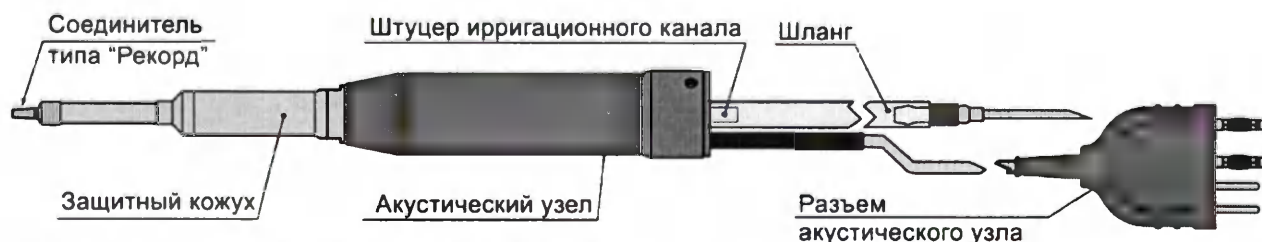
Рисунок 22а – Узел акустический ультразвуковой со сменным защитным кожухом. Исполнение 2. В сборе для аппарата моделей «АСТИТОН-АВ» и «АСТИТОН-В». Кожух сменный исполнения 2.
