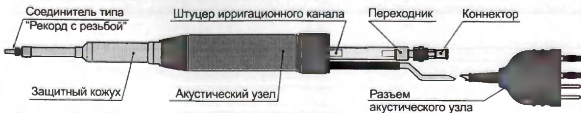
Рисунок 24 – Узел акустический ультразвуковой со сменным защитным кожухом. Исполнение 4. В сборе для аппарата моделей «ACTITON-A» и «ACTITON». Кожух сменный исполнения 4.
