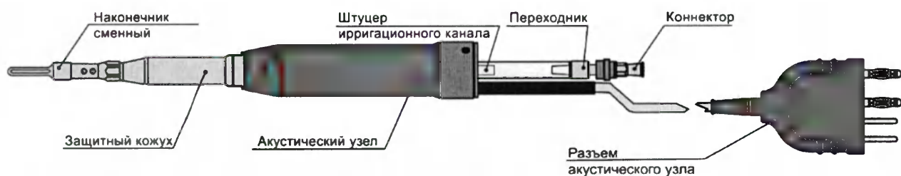
Рисунок 21 – Узел акустический ультразвуковой со сменным защитным кожухом. Исполнение 1. В сборе для аппарата моделей «АСТИТОН-А» и «АСТИТОН». Кожух сменный исполнения 6, наконечник сменный исполнения 2.
