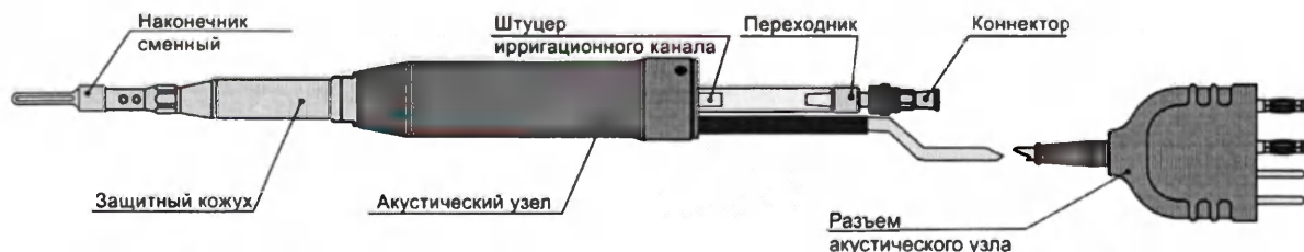
Рисунок 18 – Узел акустический ультразвуковой с защитным кожухом. Исполнение 4. В сборе для аппарата моделей «АСТИТОН-А» и «АСТИТОН».
