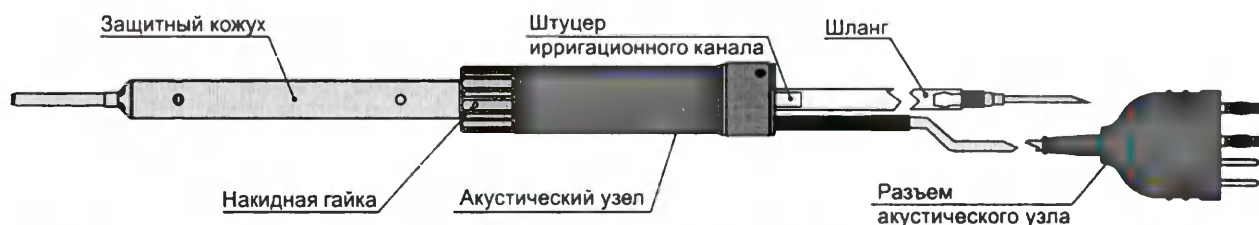
Рисунок 15а – Узел акустический ультразвуковой с защитным кожухом. Исполнение 2. В сборе для аппарата моделей «АСТИТОН-АВ» и «АСТИТОН-В».
