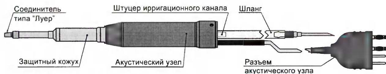
Рисунок 23а – Узел акустический ультразвуковой со сменным защитным кожухом. Исполнение 3. В сборе для аппарата моделей «АСТИТОН-АВ» и «АСТИТОН-В». Кожух сменный исполнения 3.
