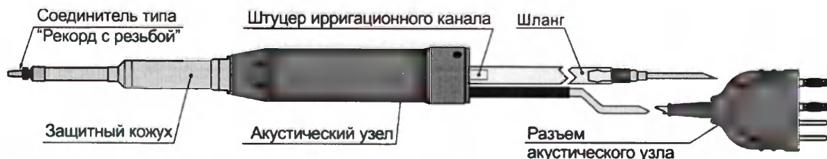
Рисунок 24а – Узел акустический ультразвуковой со сменным защитным кожухом. Исполнение 4. В сборе для аппарата моделей «ACTITON-AB» и «ACTITON-B». Кожух сменный исполнения 4.
