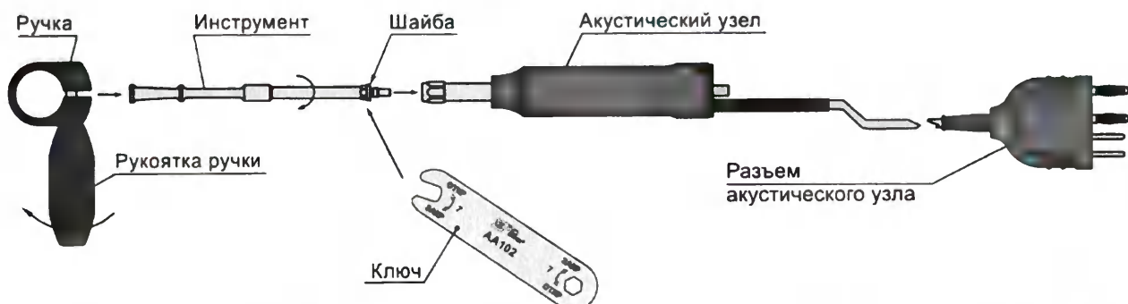
Рисунок 11 – Сборка узла акустического ультразвукового с возможностью установки сменного инструмента. Исполнение 3.
