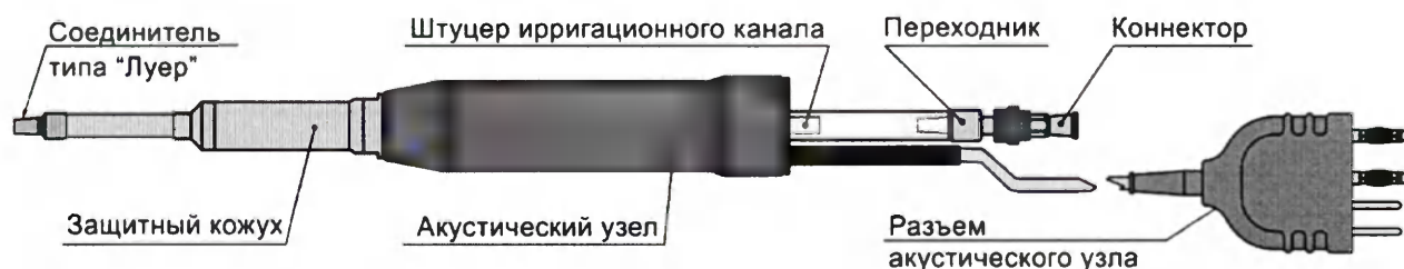
Рисунок 23 – Узел акустический ультразвуковой со сменным защитным кожухом. Исполнение 3. В сборе для аппарата моделей «АСТИТОН-А» и «АСТИТОН». Кожух сменный исполнения 3.
