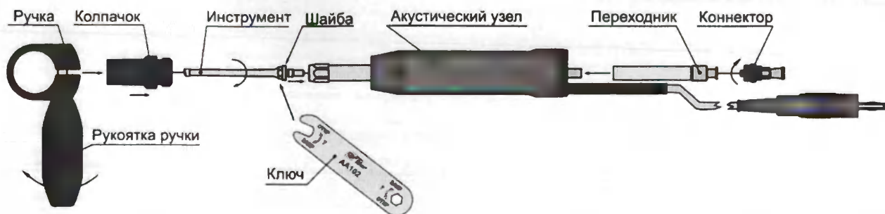
Рисунок 9 – Сборка узла акустического ультразвукового с возможностью установки сменного инструмента. Исполнения 1 и 2.
