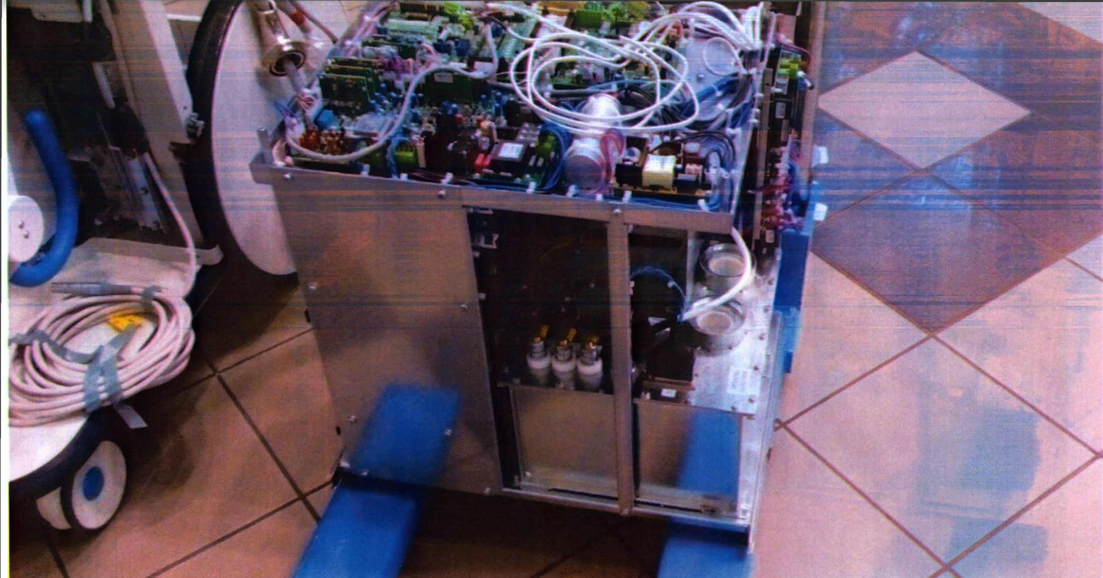
2. Устройство рентгеновское питающее высокочастотное, модель TOP-X 100LC, Innomed Medical Zrt., Венгрия
