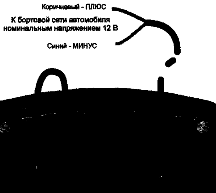
Рисунок 4.3 – Укладка шнура питания от бортовой сети автомобиля
