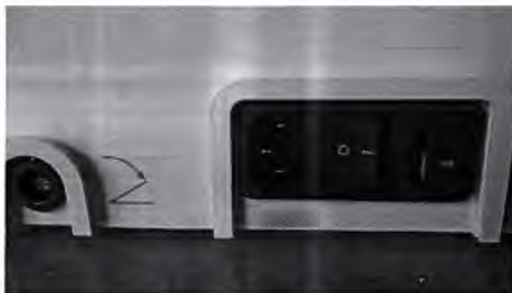
Рис. 3. Разъем для педали на задней панели блока управления.
