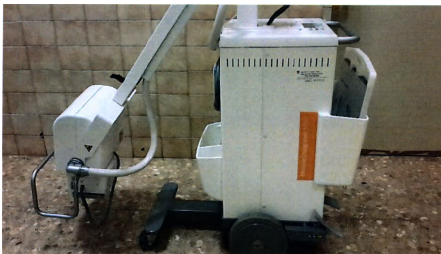
Рисунок 19. Генератор (находится внутри базового блока).
