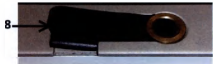
Рис. 15: Защита разъема резервного кабеля.
