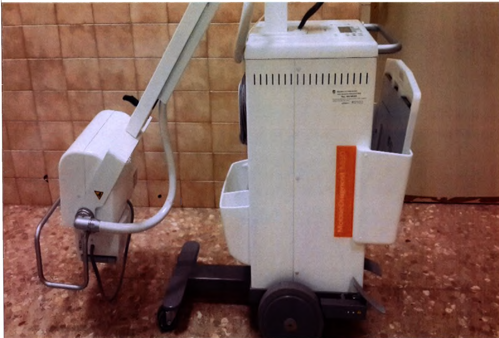
1с. Моноблок: 1.1 Рентгеновская трубка; 1.2 Генератор 16кВт/32 кВт; 1.3 Кронштейн трубки.
