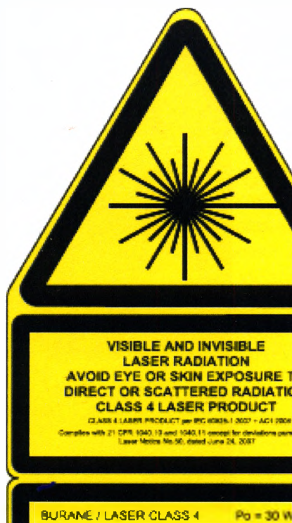
Рисунок 43: Предупредительные и рекомендательные знаки на задней панели лазерного устройства
