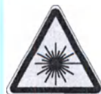
Рисунок 49: Маркировка лазерного излучения (модулей)
