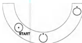
Рисунок 47: Маркировка переключателя с ключом с указанием трех положений (справа на лево: ОТКЛ., ВКЛ., ПУСК)
