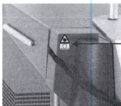
Маркировка лазерного излучения (защитная панель закрыта)
